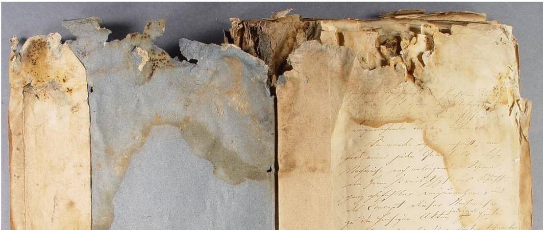
Abb.3: Schimmelschaden, Feuchteschaden, Verschmutzung, mechanische Schäden.
